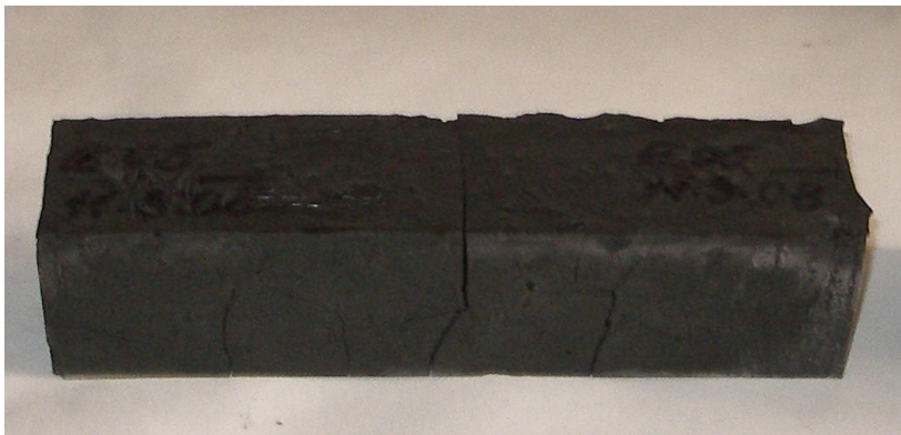
Obr. 1 Trhliny na netemp. Vzorku po 90 dnech
